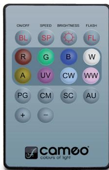
Activer le pilotage par la télécommande infrarouge dans les paramètres système de réglage sous « IR Remote » (IR Remote On). Diriger ensuite la télécommande infrarouge par contact visuel directement vers le capteur infrarouge situé sur la face avant du projecteur. Sa portée maximale est d'environ 8 mètres. Désactivez le pilotage par télécommande infrarouge (IR Remote Off) dès que vous souhaitez piloter le projecteur via W-DMX.
