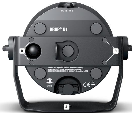
Um die Tilt-Funktion mittels Tilt-Schraube bei der Verwendung als Uplight wirksam nutzen zu können und um eine dezenterer Optik zu erzielen, muss der Montagebügel demontiert werden, indem Sie die vier Torxschrauben T10 (B), die den Montagebügel am Scheinwerfergehäuse halten, mit einem geeigneten Werkzeug lösen.
