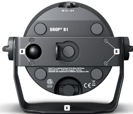
Per poter utilizzare efficacemente la funzione Tilt con l'apposita vite quando viene utilizzata come proiettore e per ottenere un aspetto più discreto, la staffa di montaggio deve essere rimossa allentando le quattro viti Torx T10 (B), che fissano la staffa di montaggio all'alloggiamento del proiettore, con un utensile adeguato.
