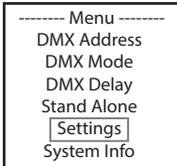
Vous accédez alors au sous-menu permettant de régler les options de sous-menu (voir tableau, sélectionner avec UP et DOWN, confirmer avec ENTER, modifier la valeur ou l'état avec UP et DOWN, confirmer avec ENTER).
