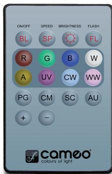
Nelle impostazioni di sistema, alla voce "IR Remote", attivare il controllo tramite telecomando a infrarossi (IR Remote On). Dirigere quindi il telecomando a infrarossi direttamente verso il sensore a infrarossi posto sul pannello frontale del proiettore. Il raggio d'azione massimo è di circa 8 metri. Quando si desidera controllare il proiettore tramite W-DMX, disattivare il controllo tramite il telecomando a infrarossi (IR Remote Off).
