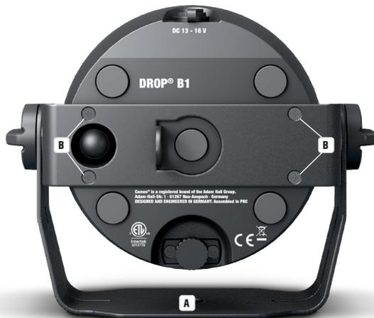
Aby móc efektywnie korzystać z funkcji pochylania ustawianej za pomocą śruby, w przypadku zastosowania urządzenia jako reflektora, i uzyskać bardziej dyskretny wygląd, należy zdemontować uchwyt montażowy przez poluzowanie za pomocą odpowiedniego narzędzia czterech śrub T10 Torx (B), które mocują wspornik montażowy do obudowy reflektora.
