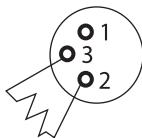
La terminaison réduit les problèmes de transmission du signal et des interférences. Nous vous conseillons de connecter toujours une terminaison DMX (résistance de 120 Ohms, 1/4 W) entre le point 2 (DMX-) et le point 3 (DMX+) du dernier appareil de la chaîne.
