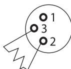
Il terminatore riduce i problemi di trasmissione del segnale e le interferenze. È sempre consigliabile collegare un terminatore DMX (resistenza 120 Ohm 1/4W) tra il pin 2 (DMX-) e il pin 3 (DMX+) dell'ultimo apparecchio.
