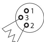
La terminación reduce los problemas de transmisión de la señal y las interferencias. Se recomienda conectar un terminador DMX, (resistencia de 120 ohmios y 1/4 W) entre el pin 2 (DMX-) y el pin 3 (DMX+) del último equipo.
