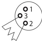
Zastosowanie zakończenia kabla zmniejszy możliwość wystąpienia problemów z transmisją sygnału i zakłóceniami. Zaleca się podłączenie elementu zakończenia linii DMX (rezystor 120 Ω, 1/4 W) pomiędzy wyprowadzenia 2 (DMX-) i 3 (DMX+) ostatniego z urządzeń.
