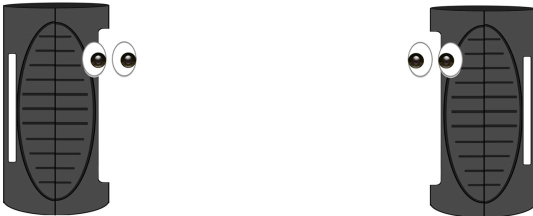
Abb. 4: Geräte der Micro-Serie wollen gesehen werden – dass sie klein sind, bedeutet nicht, dass sie in einer Kiste arbeiten wollen! Sie sind mit einer sehr empfindlichen Antenne ausgestattet, die keine Hindernisse mag. Achten Sie vor allem darauf, dass ihre Displays zueinander zeigen – so erreichen Sie eine optimale Leistung!
