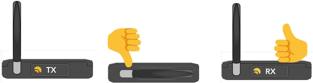
Abb. 1: Es ist wichtig, dass alle Antennen in derselben Achse ausgerichtet sind – WLAN-Signale breiten sich kreisförmig aus und das sollte berücksichtigt werden. Es gibt verschiedenes Zubehör, das zur Aufrechterhaltung der Richtionalität beitragen kann.
