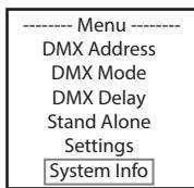
Spowoduje to przejście do podmenu umożliwiającego wywołanie informacji systemowych (patrz tabela) — wybór przyciskami UP i DOWN, potwierdzenie przyciskiem ENTER, zmiana statusu przyciskami UP i DOWN, potwierdzenie przyciskiem ENTER.
