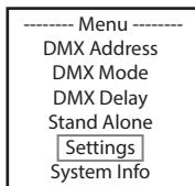
Nastąpi przejście do podmenu, w którym można dokonać ustawień punktów podmenu (patrz tabela, wybór przyciskami UP i DOWN, potwierdzenie przyciskiem ENTER, zmiana wartości lub statusu przyciskami UP i DOWN, potwierdzenie przyciskiem ENTER).
