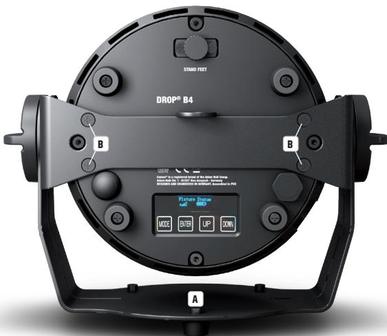
Um die Tilt-Funktion mittels Tilt-Schraube bei der Verwendung als Uplight wirksam nutzen zu können und um eine dezentere Optik zu erzielen, muss der Montagebügel demontiert werden, indem Sie die vier Torxschrauben T20 (B), die den Montagebügel am Scheinwerfergehäuse halten, mit einem geeigneten Werkzeug lösen.
