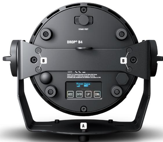
Aby móc efektywnie korzystać z funkcji pochylenia ustawianej za pomocą śruby, w przypadku zastosowania urządzenia jako reflektora, i uzyskać bardziej dyskretny wygląd, należy zdemontować uchwyt montażowy przez poluzowanie za pomocą odpowiedniego narzędzia czterech śrub T20 Torx (B), które mocują wspornik montażowy do obudowy reflektora.
