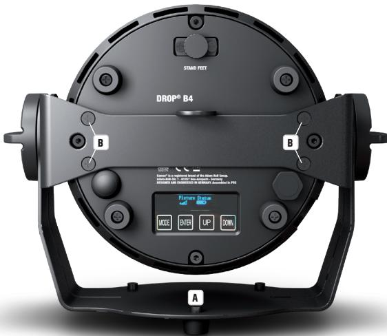
En caso de utilización como foco de luz vertical, para poder utilizar la función de inclinación de manera eficaz con el tornillo de inclinación y lograr un aspecto más discreto, se debe desmontar el soporte de montaje aflojando los cuatro tornillos Torx T20 (B), que fijan el soporte de montaje a la carcasa del foco, con una herramienta adecuada.
