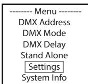
Seguidamente se abre el submenú que permite ajustar las opciones de submenú (ver tabla; se seleccionan con los botones UP y DOWN y se confirman con ENTER. También los valores o el estado se cambian con los botones UP y DOWN y se confirman con ENTER).
