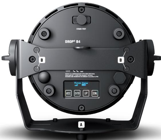
Per poter utilizzare efficacemente la funzione Tilt con l'apposita vite quando viene utilizzata come proiettore e per ottenere un aspetto più discreto, la staffa di montaggio deve essere rimossa allentando le quattro viti Torx T20 (B), che fissano la staffa di montaggio all'alloggiamento del proiettore, con un utensile adeguato.
