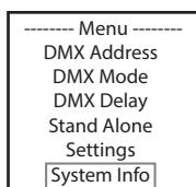
A continuación llegará al submenú que permite acceder a la información del sistema (consulte la tabla, selección con los botones UP y DOWN; confirmación con ENTER; modificación del estado con UP y DOWN; confirmación con ENTER).
