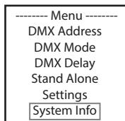
Vous accédez alors au sous-menu permettant d'appeler les informations système (voir tableau, sélectionner avec UP et DOWN, confirmer avec ENTER, modifier l'état avec UP et DOWN, confirmer avec ENTER).
